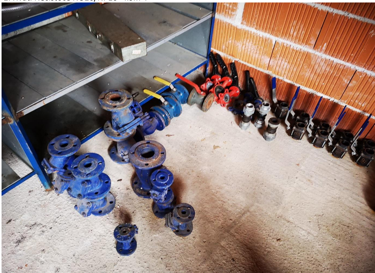
2. Hvat. Nečistoće NO20/NP16 - kom 4
