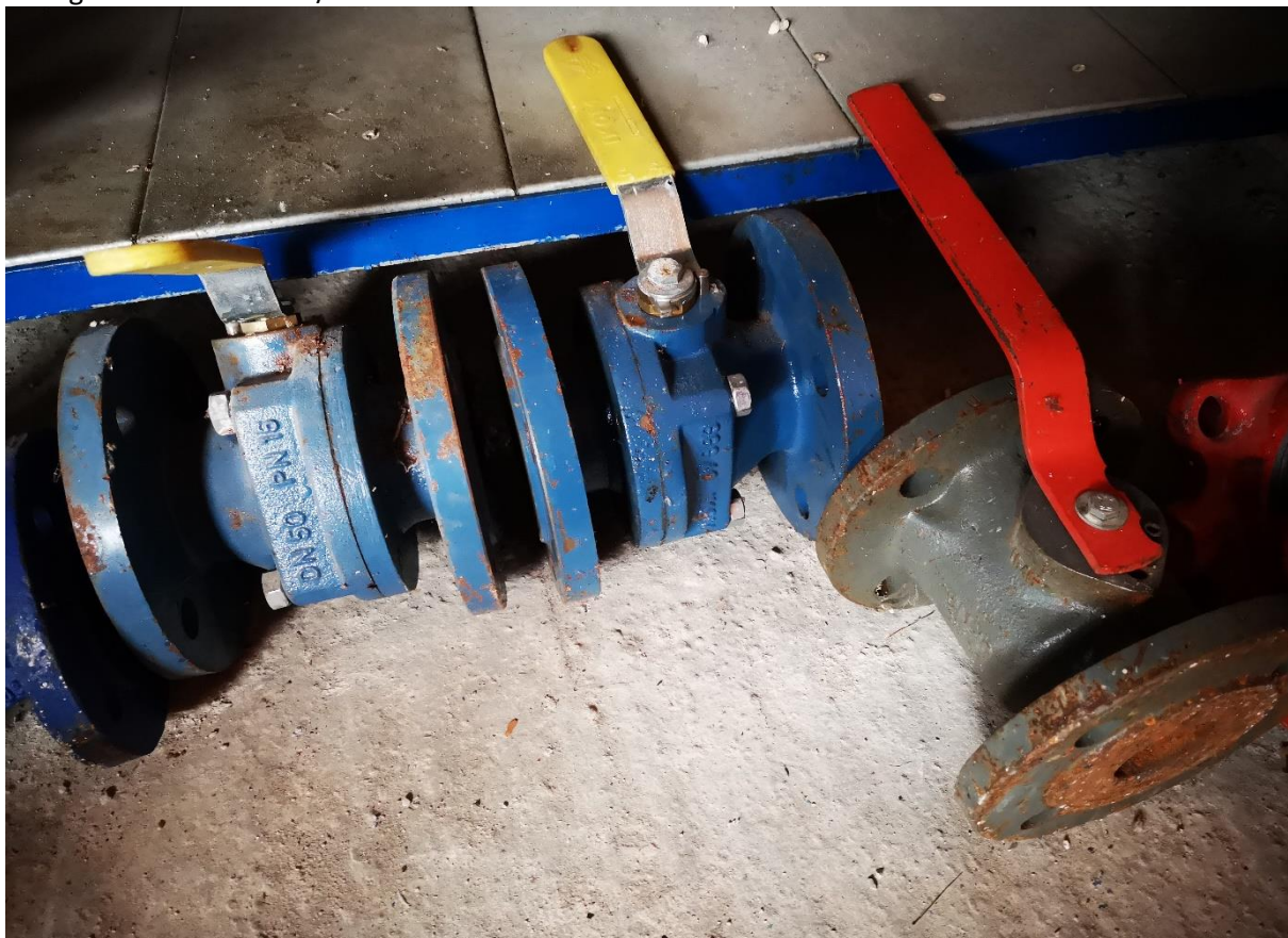
6. Kuglasta slavina DN40/NP16 - kom 3
