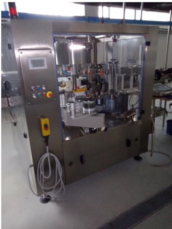
Linija za punjenje, ispiraćica punilica čepilica transportna traka, etiketirka plot stroj
