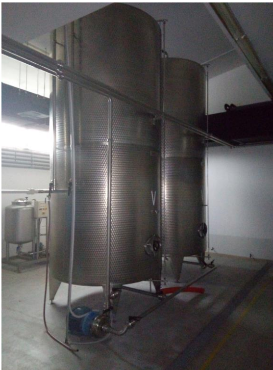
Aparatura za filtraciju, filteri tekućina , punilica , inox spremnici stojeći, pumpa, cjevovod
